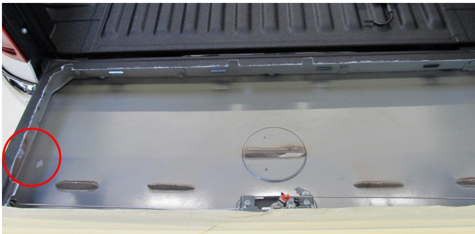
Verbindung der Längsstrebe zur Aussenflanke
